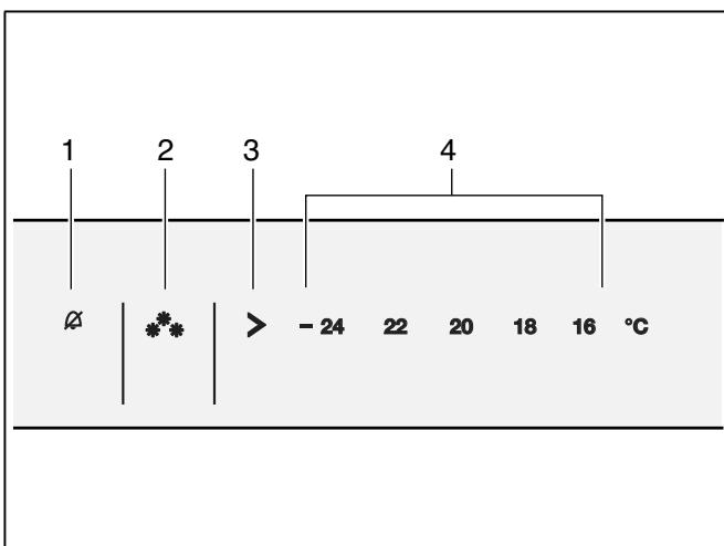
Нажмите на кнопку «Быстро» 2. Кнопка светится при включенном быстром замораживании.
