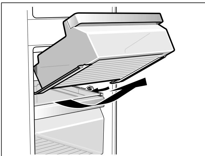
Откройте крышку морозильного отделения и снимите ее с установочного болта, придерживая его.
