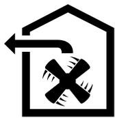
O ar aspirado é limpo nos filtros de gordura e transportado para o exterior, através de um sistema de tubagens.
