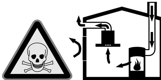
Εστίες, εξαρτημένες από τον αέρα του περιβάλλοντος (π.χ. συσκευές θέρμανσης που λειτουργούν με αέριο, λάδι, ξύλο ή άνθρακα, θερμοσίφωνες γκαζιού, θερμαντήρες νερού, βάσεις εστιών και φούρνοι) λαμβάνουν τον αέρα για καύση από το χώρο τοποθέτησης και οδηγούν τα καυσαέρια μέσα από μια εγκατάσταση απαγωγής των καυσαερίων (π.χ. καμινάδα) στο εξωτερικό χώρο.
