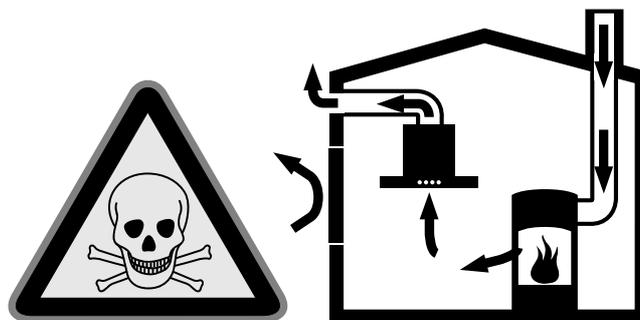
Equipamentos de aquecimento que dependem do ar ambiente (p. ex. sistemas de aquecimento a gás, óleo, lenha ou carvão, esquentadores, cilindros, placas de fogão e fornos) vão buscar o ar necessário à combustão ao espaço de montagem e transportam os gases de combustão para o exterior através de uma unidade de combustão (p. ex. uma chaminé).
