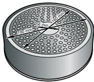
Om goede kookresultaten te verkrijgen, is het raadzaam dat de diameter van de ferromagnetische zone van de pan aangepast is aan de maat van de kookzone. Als de pan in een kookzone niet wordt gedetecteerd, probeer hem dan op de zone met een iets kleinere diameter.
