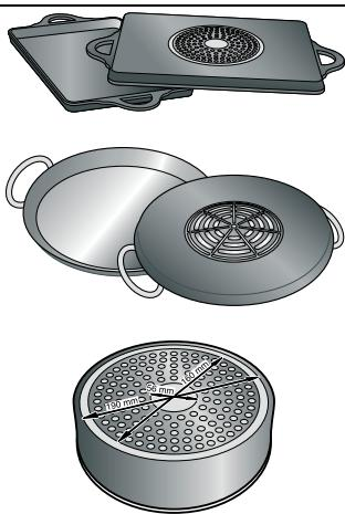
Se si utilizzano grandi recipienti con un'area ferromagnetica di diametro inferiore, si riscalda soltanto la zona ferromagnetica, per cui la distribuzione del calore potrebbe non essere omogenea.
