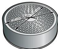
Afin d'obtenir de bons résultats de cuisson, le diamètre de la surface ferromagnétique devrait être adapté à la taille de la zone de cuisson. Si le récipient n'est pas détecté sur une zone de cuisson, l'essayer sur la zone de diamètre immédiatement inférieure.
