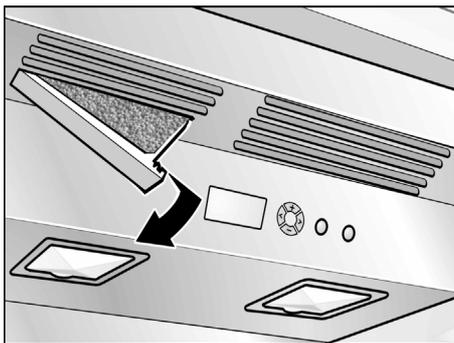
2. Estrarre il filtro saturo e sostituirlo con il filtro nuovo.
