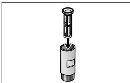
2. Вставьте уплотнитель в корпус фильтра и подсоедините к водопроводному крану (резьбовое соединение 3/4").
