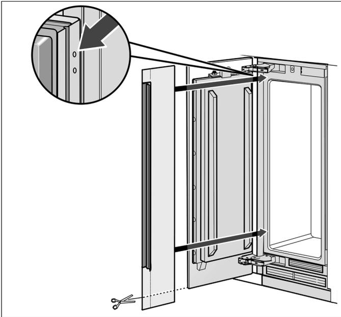
2. Fingerschutz in den Spalt zwischen Gerät und Nischenwand einschieben (1.).
