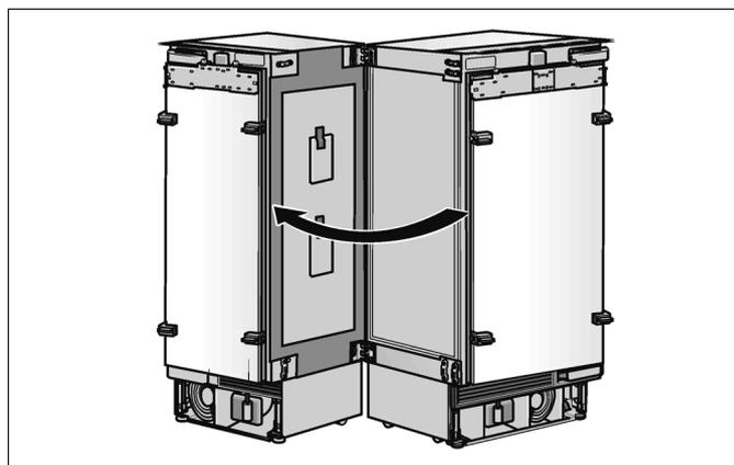
11. Schrauben an der Geräteoberseite heraus-schrauben und stattdessen die Kippsicherungs-winkel als Montagehilfe anschrauben.
