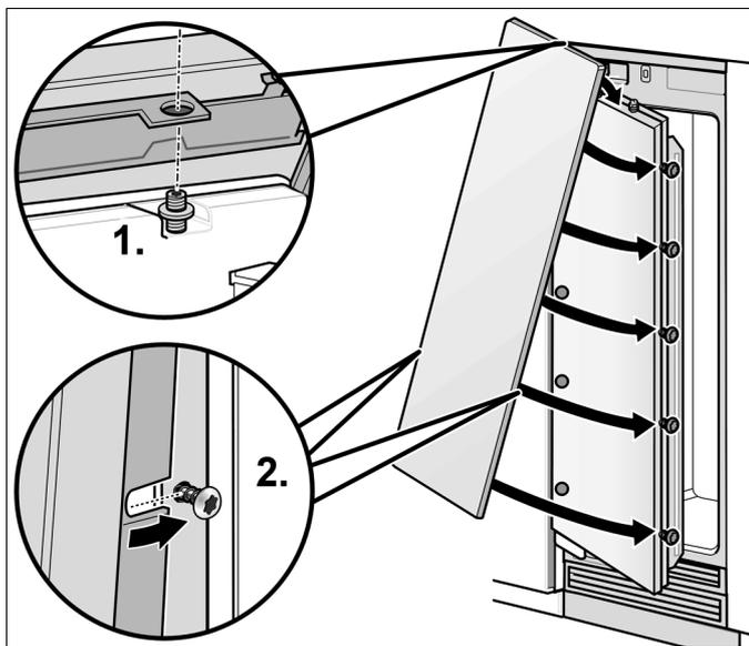
6. Möbeltür mit den Gewindebolzen ausrichten (Torx-Schraubendreher). Spaltmaß umlaufend kontrollieren.
