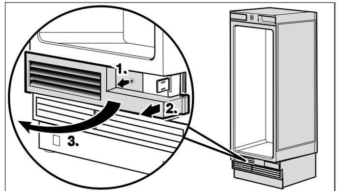
6. Lüftungsgitter für den geänderten Türanschlag neu montieren.
