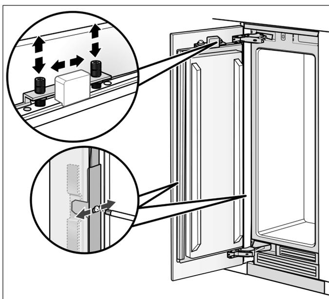
10. Muttern auf die Gewindebolzen der Justierschiene drehen und festziehen! Hierdurch wird die seitliche Ausrichtung der Tür fixiert.
