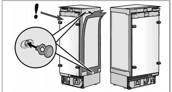
5. Die feuchtigkeitsabsorbierenden Streifen aus dem Installationszubehör für Side-by-Side Aufstellung auf der Seitenwand mit Klebestreifen befestigen.
