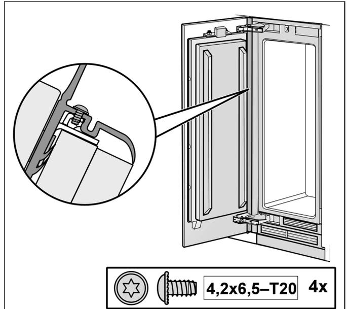
5. Funktion und Leichtgängigkeit des Fingerschutzes durch mehrmaliges Öffnen und Schließen der Tür prüfen.
