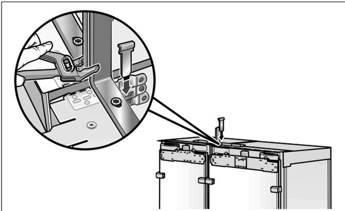
14. Geräte mit Hilfe einer Wasserpumpenzange am Gerätesockel vollständig zusammendrücken.
