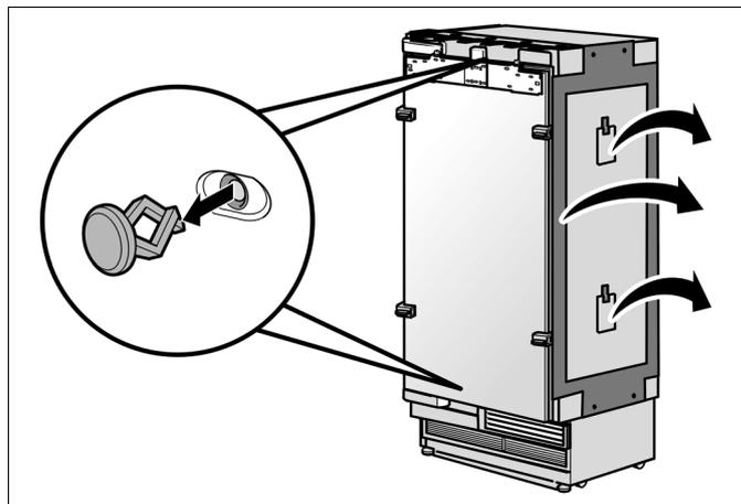
Für die Side-by-Side Aufstellung ist die Dichtungsmatte unbedingt erforderlich.
