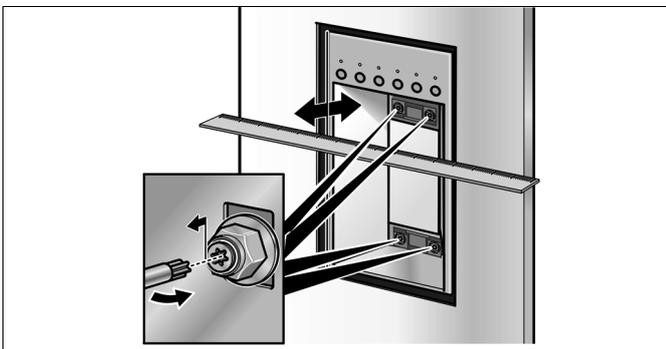
3. Durch Verschieben per Hand den Eis- und Wasserspender seitlich und in der Höhe ausrichten, so dass umlaufend exakt der gleiche Abstand zum Türpanel vorhanden ist.
