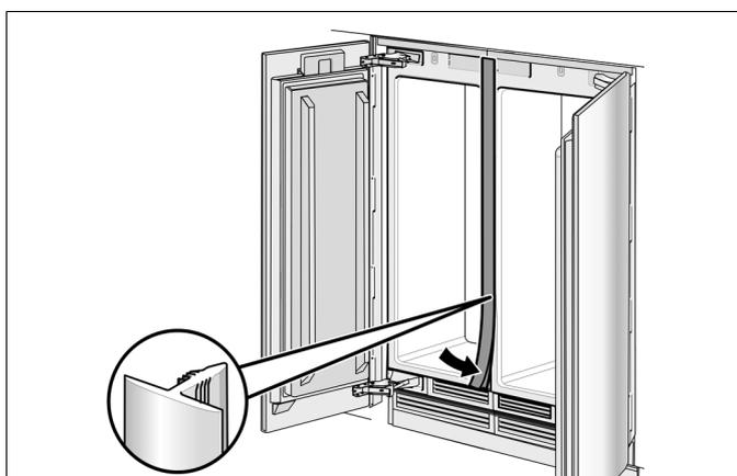
Die Abdeckschiene in den Spalt zwischen den Geräten einfügen.
