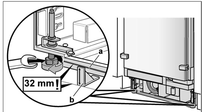
3. Mit den Füßen an der Rückseite das Gerät senkrecht ausrichten. Wasserwaage benutzen!
