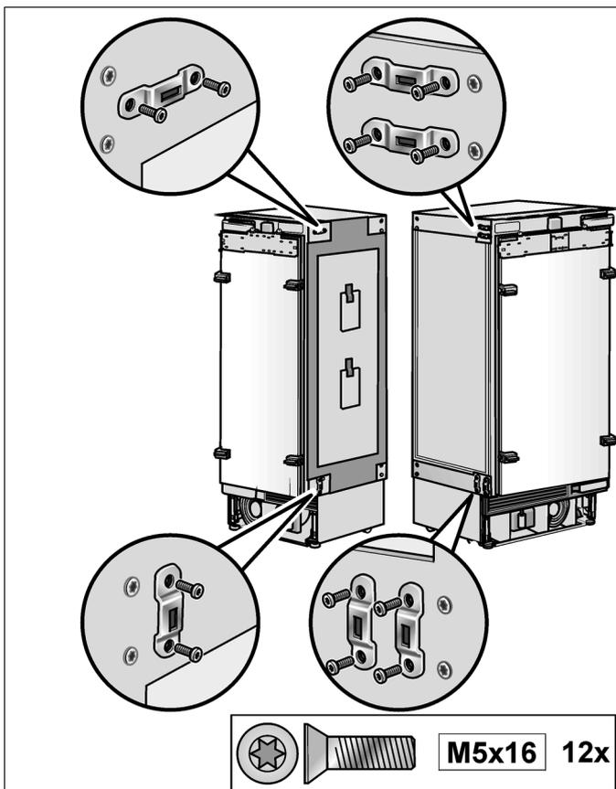
7. Verbindungswinkel aus dem Installationszubehör für Side-by-Side Aufstellung jeweils auf der Griffseite an beiden Geräten anschrauben.
