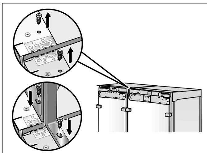
12. Geräte mit Hilfe einer Wasserpumpenzange an den Montagehilfen vollständig zusammendrücken.
