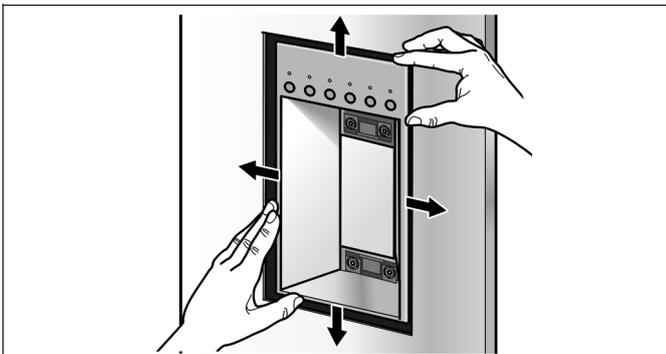
4. Die Muttern an den Stellschrauben wieder festziehen, um die Ausrichtung zu fixieren.
