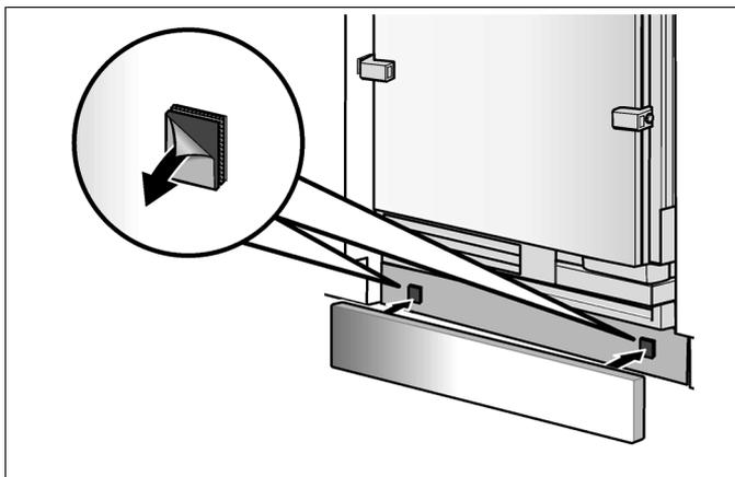
5. Sockelleiste kann von hinten mit der Sockelverkleidung verschraubt werden. In der Sockelverkleidung sind dazu Löcher vorhanden.
