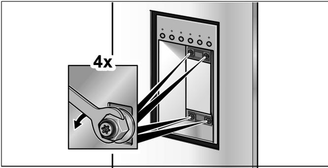
2. Mit einem Torx-Schraubendreher den Eis- und Wasserspender an den Stellschrauben in der Tiefe ausrichten.
