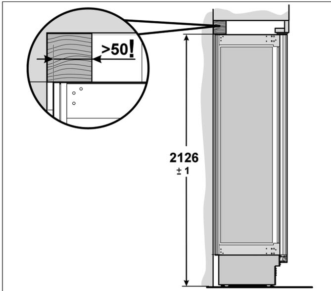
2. Die Installationshöhe (Unterkante der Bohle) an der Rückwand der Nische kennzeichnen.
