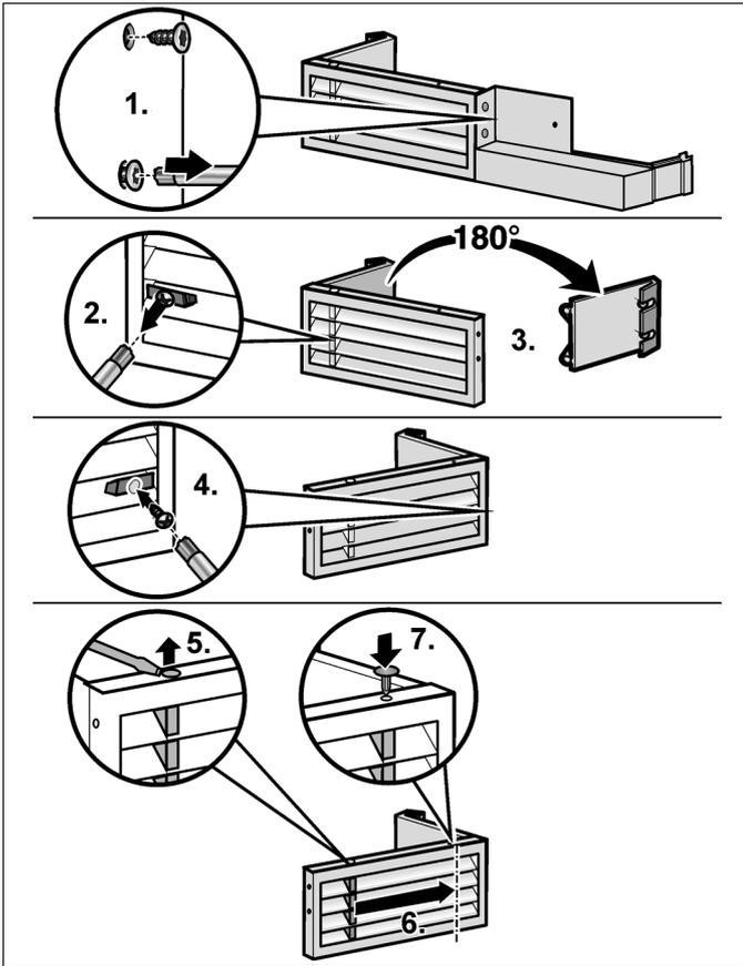
Zur Anpassung an den geänderten Türanschlag liegt dem Gerät ein Austauschteil für das Lüftungsgitter bei.
