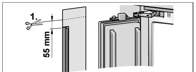
2. Abgeschnittenes Reststück auf der Anschlagseite in den Spalt zwischen Gerät und Nischenwand schieben. Das Teil muss sich leicht hineinschieben und herausziehen lassen (2.)!
