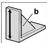
Zur korrekten Einstellung dieser Höhe wird die Montagelehre (b) benutzt. Die Oberkante der Lehre muss mit der Markierung am Gerät übereinstimmen.
