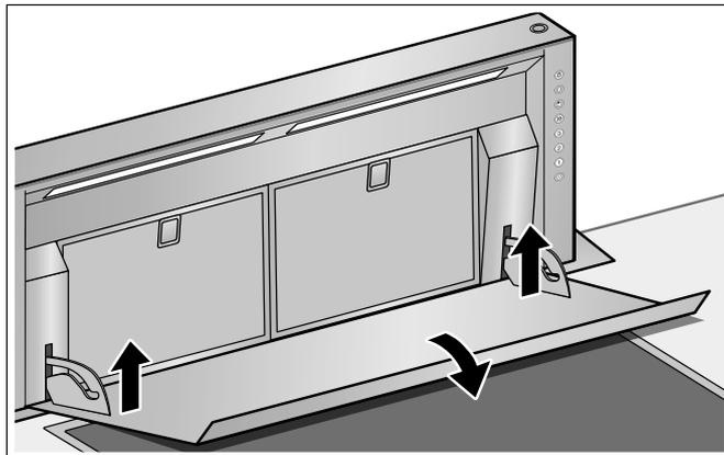
Se puede tirar de la tapa del filtro mediante los pernos del soporte.
