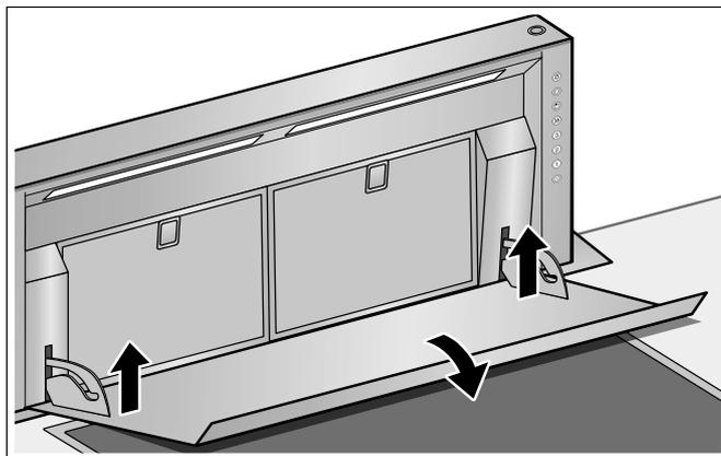
Le capot du filtre peut être tiré par-dessus les axes du support.
