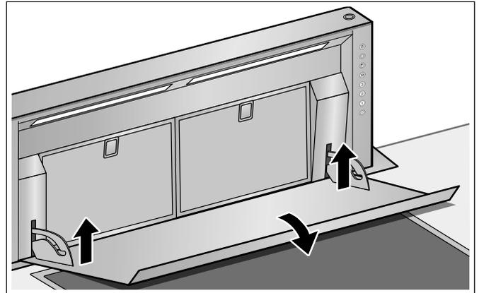
Die Filterabdeckung lässt sich über die Bolzen der Halterung ziehen.
