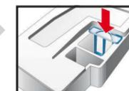
5. Kondenswasser-Behälter einschieben bis zum Einrasten.
