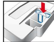
5. Kondenswasser-Behälter einschieben bis zum Einrasten.
