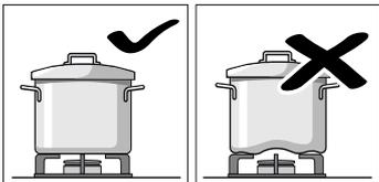
No utilice recipientes deformados que se muestren inestables sobre la placa de cocción. Los recipientes podrían volcar.
