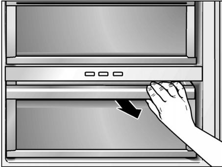
Die Filterabdeckung abheben, Filter herausnehmen.
