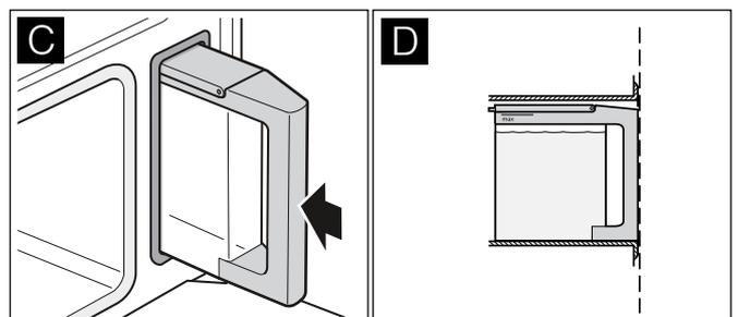
Der Tank muss bündig mit dem Tankschacht sein (Bild D).
