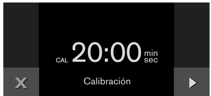
Comienza el proceso de calibración. En la pantalla se muestra el tiempo que falta.
