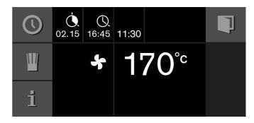
El aparato pasa a la posición de espera. En la pantalla aparecen el modo de funcionamiento, la temperatura, el tiempo de cocción y el fin del tiempo de cocción. El aparato comienza en el momento calculado y se apaga automáticamente una vez transcurrido el tiempo de cocción.
