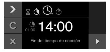
3 Ajuste con el selector giratorio el fin del tiempo de cocción que desee.
