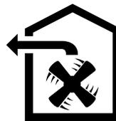
Zassane powietrze jest oczyszczone przez filtr przeciwtłuszczowy i kierowane na zewnątrz poprzez system rur.
