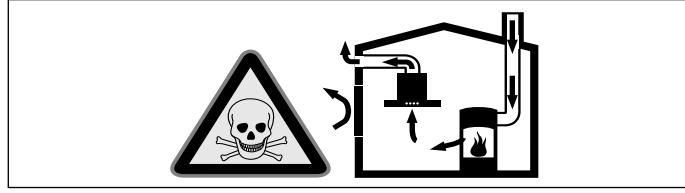
Εστίες, εξαρτημένες από τον αέρα του περιβάλλοντος (π.χ. συσκευές θέρμανσης που λειτουργούν με αέριο, πετρέλαιο, ξύλο ή άνθρακα, ταχυθερμοσίφωνες, θερμαντήρες νερού) λαμβάνουν τον αέρα για καυση στο ίδιο το χώρο τοποθέτησης και οδηγούν τα καυσαέρια μέσα από μια εγκατάσταση απαγωγής των καυσαέριων (π.χ. καυνιόδα) στον έξω χώρο.
