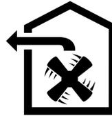
El aire aspirado se depura a través de filtros antigrasa y se evacua al exterior mediante un sistema de conductos.
