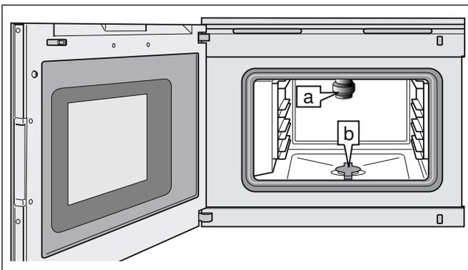
El programa de limpieza elimina la suciedad persistente. Enrosca un cartucho de limpieza (a) en la parte superior del compartimento de cocción. El compartimento de cocción se limpia, enjuaga y seca de forma completamente automática. El filtro (b) debe permanecer colocado en la base del compartimento de cocción durante el programa de limpieza.
