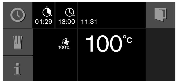
Cuando falte un minuto para terminar el tiempo de cocción, se muestra ampliada la cuenta del tiempo de cocción en la pantalla.
