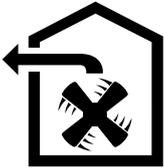
El aire aspirado se depura a través de filtros antigrasa y se evacua al exterior mediante un sistema de tubos.
