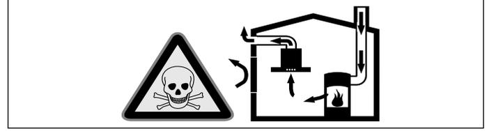
Hava dolaşımli ateşlikler (örneğin gaz, yağ, odun veya kömürle çalışan sobalar, şofbenler, su ısıtıcıları) yanma havasını kurulum yerinden alırlar ve atık gazı bir atık gaz sistemi (örneğin baca) kanalıyla dışarıya aktarırlar.
