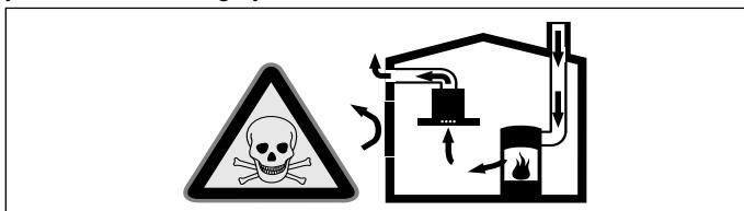
Hava dolaşılık ateşlikler (örneğin gaz, yağ, odun veya kömürle çalışan sobalar, şöfbenler, su ısıtıcıları) yanma havasını kurulum yerinden alırlar ve atık gazi bir atık gaz sistemi (örneğin baca kanalıyla dışarıya aktarırlar).
