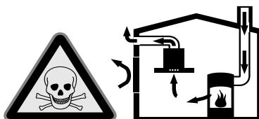
Εστίες, εξαρτημένες από τον αέρα του περιβάλλοντος (π.χ. συσκευές θέρμανσης που λειτουργούν με αέριο, πετρελαϊο, ξύλο ή άνθρακα, ταχυθερμοσίφωνες, θερμαντήρες νερού) λαμβάνουν τον αέρα για καύση από το χώρο τοποθέτησης και οδηγούν τα καυσαερία μέσα από μια εγκατάσταση απαγωγής των καυσαερίων (π.χ. καμινάδα) στον ίδιο χώρο.
