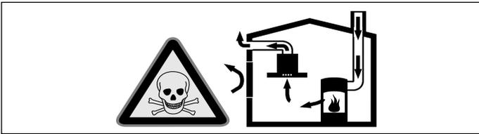
Eldstæder som er beroende af rumluft (t.ex. varmeapparater som drives med gas, olie, ved eller kol, gennemstrømningsapparater, varmvattenberedere) tar sin forbrændingsluft ur det utrymme där enheten är installerad och leder ut avgaserna i det fria via en avgasanläggning (t.ex. skorsten).
