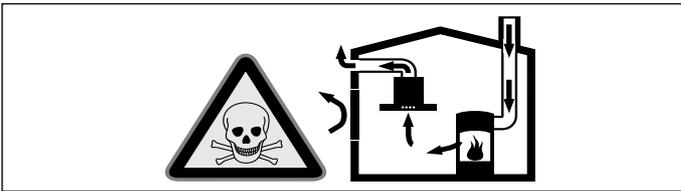
Топки із підведенням повітря із приміщення (напр., опалювальні установки, які працюють на газі, рідкому паливі, дровах чи вугіллі, проточні нагрівачі, бойлери) забирають повітря для горіння палива із приміщення, де вони установлені, а газу, що виділяється при цьому, відходять через витяжну систему (напр., димохід) на вулицю.
