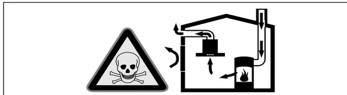
Zależne od powietrza w pomieszczeniu urządzenia spalające (np. grzejniki na gaz, olej, drewno lub węgiel, przepływowe podgrzewacze wody i inne podgrzewacze wody) pobierają powietrze do spalania z pomieszczenia, w którym się znajdują, a spaliny odprowadzają przez układ wylotowy (np. komin) na zewnątrz.
