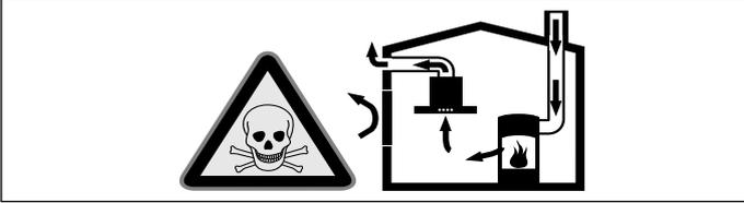
Hava dolaşımli ateşlikler (örneğin gaz, yağ, odun veya kömürle çalışan sobalar, şöfenler, su ısıtıcıları) yanma havasını kurulum yerinden alırlar ve atık gazı bir atık gaz sistemi (örneğin baca) kanalıyla dışarıya aktarırlar.
