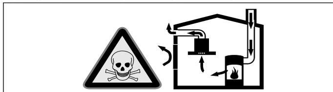
Εστίες, εξαρτημένες από τον αέρα του περιβάλλοντος (π.χ. συσκευές θέρμανσης που λειτουργούν με αέριο, πετρέλαιο, ξύλο ή άνθρακα, ταχυθερμοσίφωνες, θερμοαντήρες νερού) λαμβάνουν τον αέρα για καύση από το χώρο τοποθέτησης και οδηγούν τα καυσαέρια μέσα από μια εγκατάσταση απαγωγής των καυσαερίων (π.χ. καμινάδα) στον έξω χώρο.
