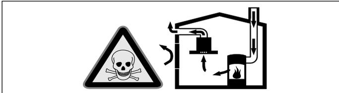
Huoneilmaa tarvitsevat tulisijat (esim. kaasu-, öljy-, puu- tai hiilikäyttöiset lämmityslaitteet, läpivirtauskuumennin, vedenkuumennin) ottavat polttoilman huoneilasta ja johtavat poistoilman poistoilmalaitteen (esim. savutorven) kautta ulos. Tuuletin imee keittiöstä ja sen viereisistä huoneista ilmaa - tämä on korvattava riittävällä tuloilmalla - muuten syntyy alipaine. Myrkylliset kaasut imeytyisivät takaisin huoneisiin savutorvesta tai poistoilmakanavasta.
