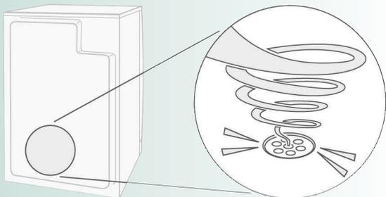
*El agua condensada se bombea mediante una bomba al recipiente de agua condensada y durante dicho proceso se generan ruidos de bombeo.*
