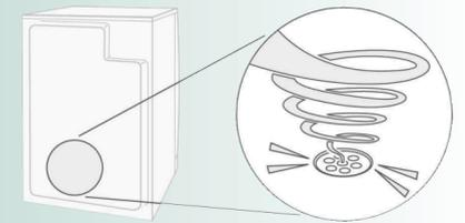
El agua condensada se bombea mediante una bomba al recipiente de agua condensada y durante dicho proceso se generan ruidos de bombeo.
