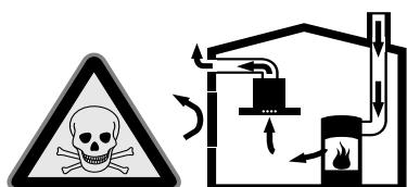
Источники пламени с подводом воздуха из помещения (например, работающие на газе, жидком топливе, дровах или угле нагреватели, проточные водонагреватели, бойлеры) получают воздух для сжигания топлива из помещения, где они установлены, а
