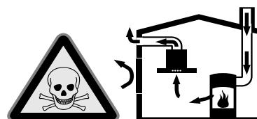
Eldständer som är beroende av rumsluft (t.ex. värmearrapparater som drivs med gas, olja, ved eller kol, genomströmningsapparater, varmvattenberedare) tar sin förbränningsslut ur det utrymme där enheten är installerad och leder ut avgaserna i det fria via en avgasanläggning (t.ex. skorsten).
