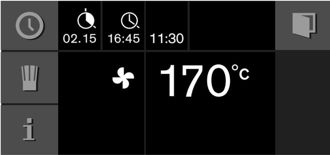
El aparato pasa a la posición de espera. En la pantalla aparecen el modo de funcionamiento, la temperatura, el tiempo de cocción y el fin del tiempo de cocción. El aparato comienza en el momento calculado y se apaga automáticamente una vez transcurrido el tiempo de cocción.
