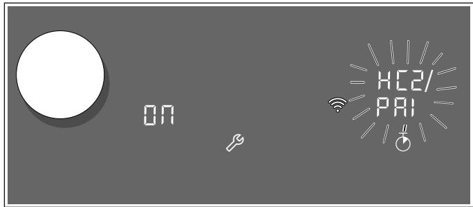
Het apparaat probeert automatisch om verbinding met de app te maken. In het instelgebied knipperen ***HC2*** en ***PR1*** afwisselend. In de kookzone-indicatie knippert de waarde ***ON***.
