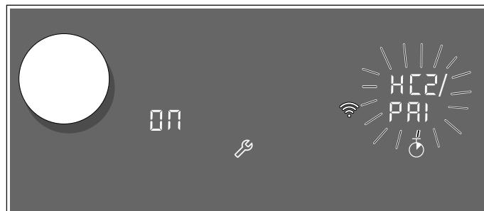
L'apparecchio prova automaticamente a connettersi all'app. Nel campo di regolazione lampeggiando in modo alternato ***HC2*** e ***PRI***. Sull'indicatore delle zone di cottura lampeggia il valore ***ON***.
