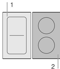
**Avvertenza:** Nell'area di cottura flessibile è possibile attivare anche la funzione booster quando l'area di cottura viene utilizzata come zona di cottura singola.
