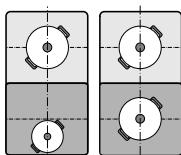
Las zonas delantera y trasera, con dos inductores cada una, pueden utilizarse de forma independiente, ajustando la potencia necesaria en cada una de ellas. En este caso se recomienda utilizar sólo un recipiente en cada zona.
