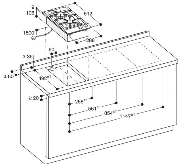
Distance minimale entre la découpe de l'appareil et la paroi latérale 150 mm.
