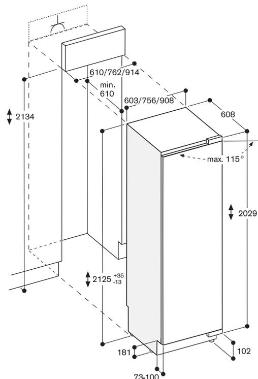
Les dimensions maximales du panneau d'habillage sont basées sur une fente de 3 mm.
