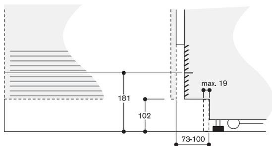
Pour la hauteur standard de l'appareil, la hauteur maximale de la plinthe doit être de 102 mm. L'épaisseur de la plinthe ne doit pas dépasser 19 mm.
