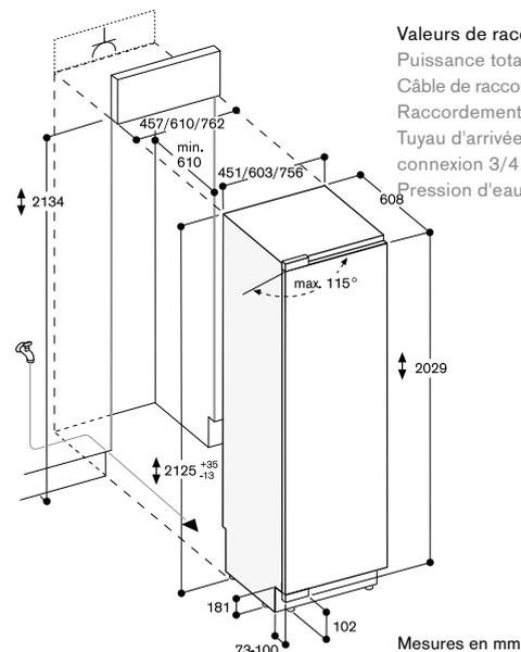
Les dimensions maximales du panneau d'habillage sont basées sur une fente de 3 mm.
