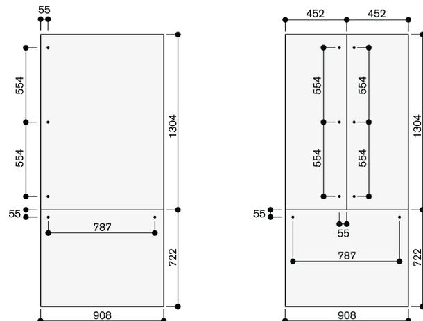
L'épaisseur du panneau d'habillage est de 19 mm. Les dimensions maximales du panneau d'habillage sont prévues pour une fente de 3 mm, basées sur une niche individuelle.
