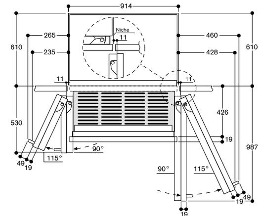
Sur ce schéma, l'épaisseur du panneau d'habillage est de 19 mm et la poignée de meuble Gaggenau est de 49 mm.
