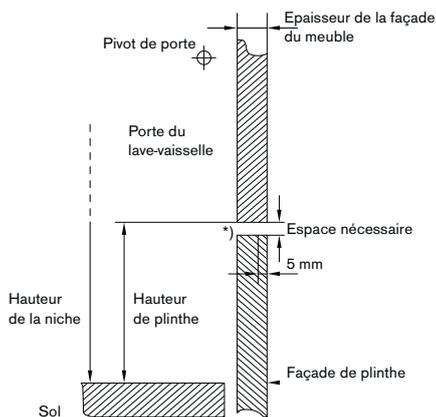
\* La zone de pivotement de la porte doit être au minimum de 4 mm.
