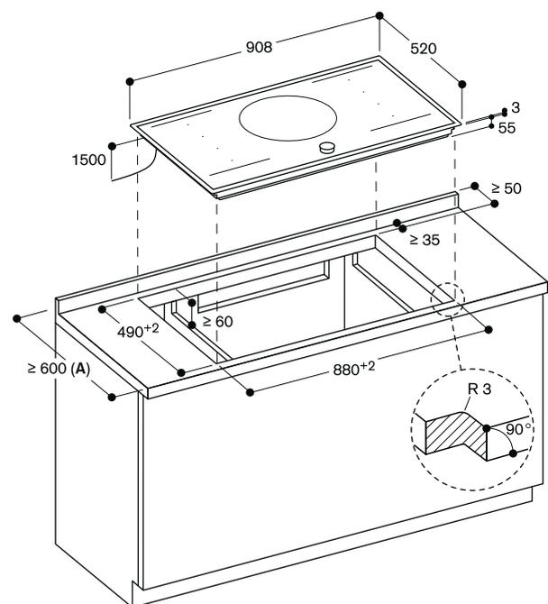
**A:** Veuillez vérifier le manuel d'installation si la profondeur du plan de travail est inférieure à 600 mm.
