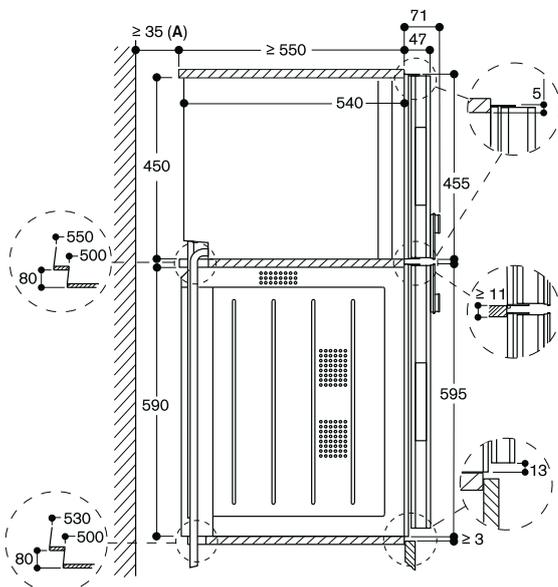
A : uniquement requis lorsque les tuyaux d'eau du BS ne peuvent pas être amenés dans les évidements en coin des appareils.
