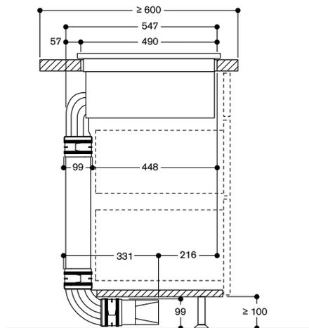
A : Non recommandé pour installation contre des murs extérieurs non isolés thermiquement ( $U 0,5 \text{ W/m}^2\text{°C}$ )
