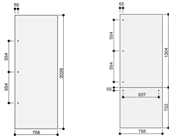
L'épaisseur du panneau d'habillage est de 19 mm. Les dimensions maximales du panneau d'habillage sont prévues pour une fente de 3 mm, basées sur une niche individuelle.
