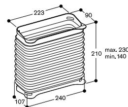
AD 851 041 : Pièce de connexion pour VL 200 pour extension avec gaine plate Ø 150 mm pour plan de travail très profond
