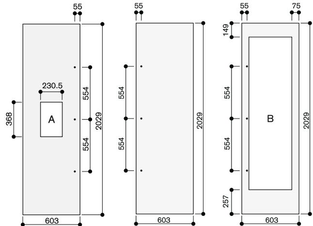
L'épaisseur du panneau d'habillage est de 19 mm. Les dimensions maximales du panneau d'habillage sont prévues pour une fente de 3 mm, basées sur une niche individuelle.
