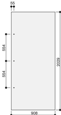
L'épaisseur du panneau d'habillage est de 19 mm. Les dimensions maximales du panneau d'habillage sont prévues pour une fente de 3 mm, basées sur une niche individuelle.
