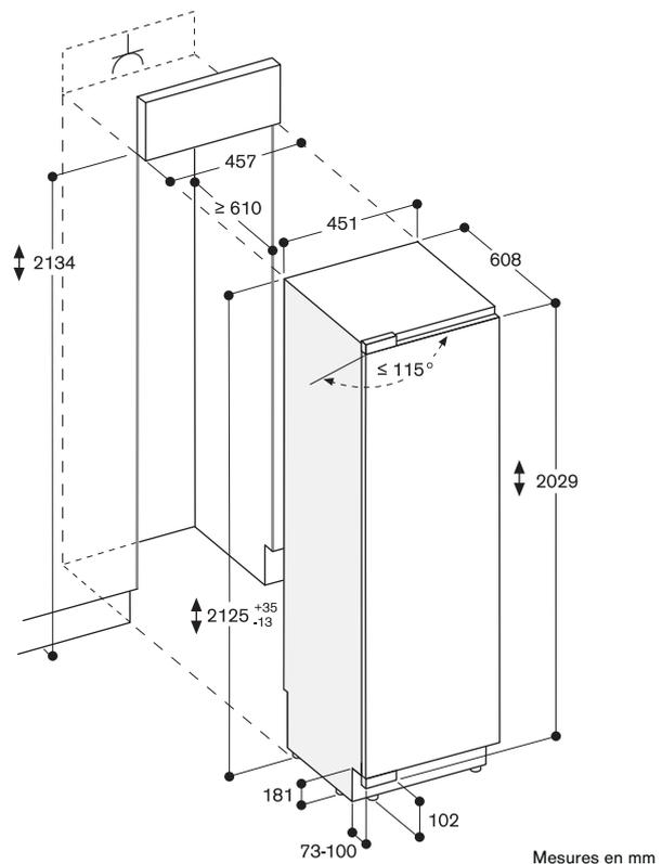
Les dimensions maximales du panneau d'habillage sont basées sur une fente de 3 mm.
