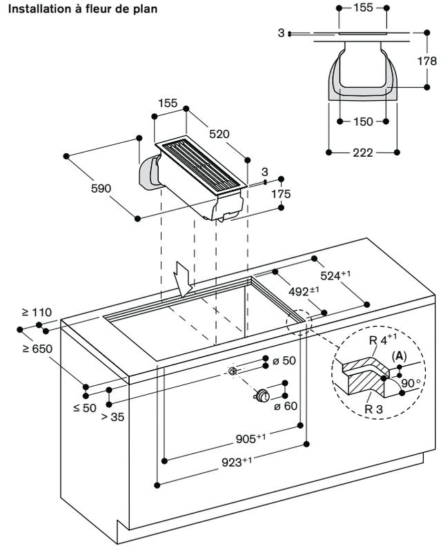
A: 3,5<sup>-0,5</sup> en combinaison avec au moins un appareil avec cadre
