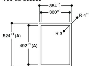
A : si installation avec un couvercle, prendre en considération la découpe la plus profonde (se référer aux schémas de montage séparés)
