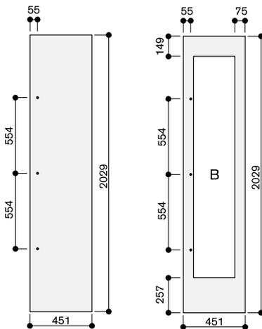
L'épaisseur du panneau d'habillage est de 19 mm. Les dimensions maximales du panneau d'habillage sont prévues pour une fente de 3 mm, basées sur une niche individuelle. B : La largeur des 2 côtés du cadre pour la cave à vin doit être comprise entre 65 mm et 82 mm.
