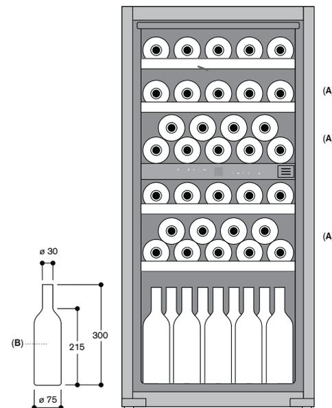
**A** : Zone appropriée pour le stockage de bouteilles magnum dans une configuration standard
