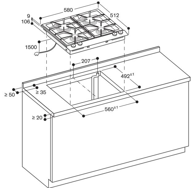
Distance minimale entre la découpe de l'appareil et la paroi latérale 150 mm.
