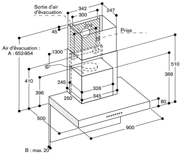
A : adapté pour des hauteurs de plafond allant de 2,25 m à 2,55 m ;
