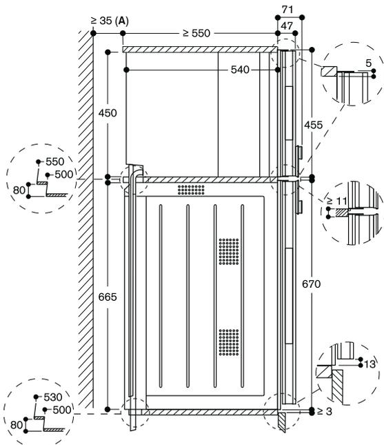
A : uniquement requis lorsque les tuyaux d'eau du BS ne peuvent pas être amenés dans les évidements en coin des appareils.
