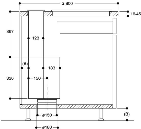
A:  $\geq 20$  mm entre la zone d'aspiration Guided Air et la paroi arrière du meuble bas
