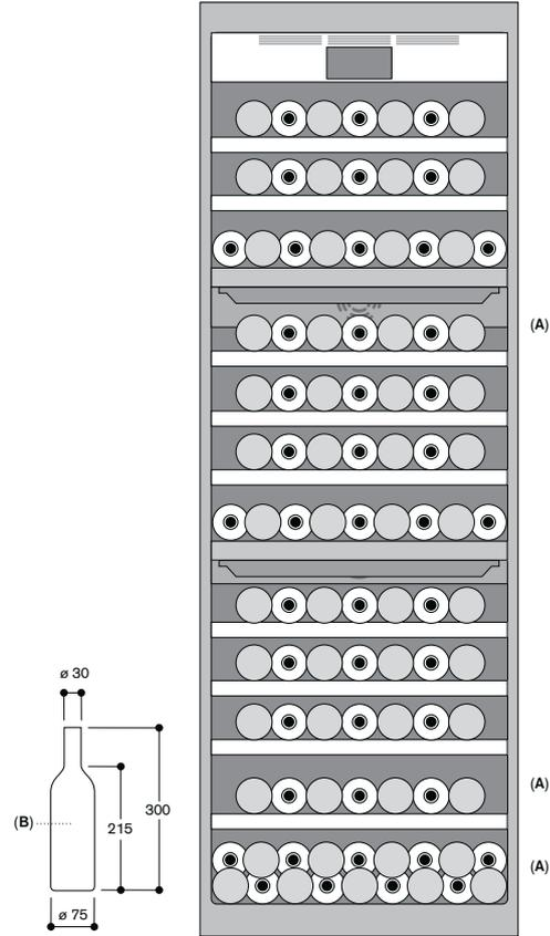
A : Zone appropriée pour le stockage de bouteilles magnum dans une configuration standard
