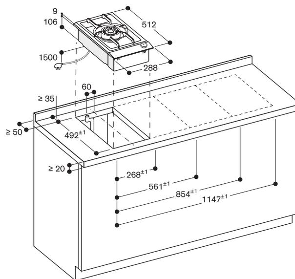
Distance minimale entre la découpe de l'appareil et la paroi latérale 150 mm.
