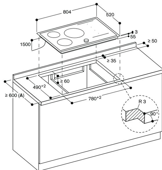
**A:** Veuillez vérifier le manuel d'installation si la profondeur du plan de travail est inférieure à 600 mm.
