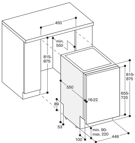
Mesures de raccordement pour lave-vaisselle de 45 cm de largeur
