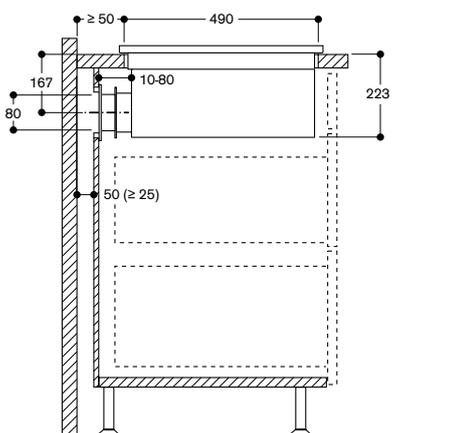
A: Non recommandé pour installation en mode recyclage contre des murs extérieurs non isolés ( $U \geq 0.5 \text{ W/m}^2\text{°C}$ )
