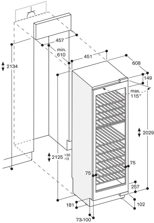
Les dimensions maximales du panneau d'habillage sont basées sur une fente de 3 mm.
