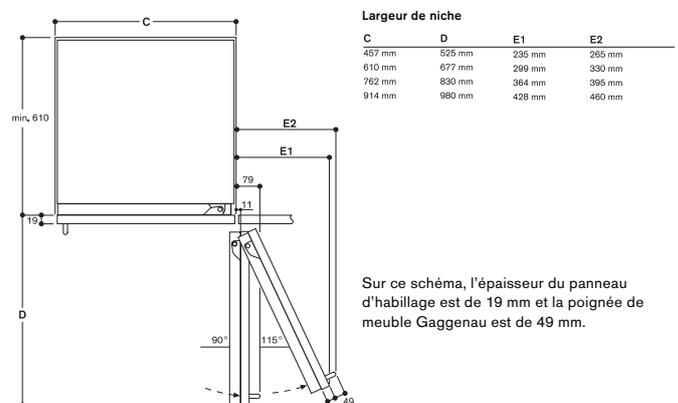
Sur ce schéma, l'épaisseur du panneau d'habillage est de 19 mm et la poignée de meuble Gaggenau est de 49 mm.
