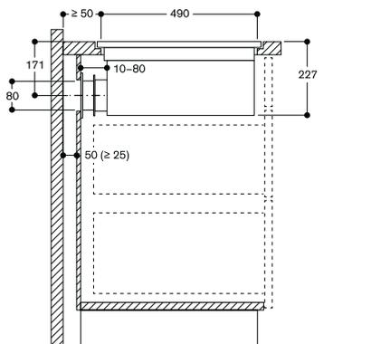
Non recommandé pour installation en mode recyclage contre des murs extérieurs non isolés ( $U \geq 0,5 \text{ W/m}^2\text{C}$ )
