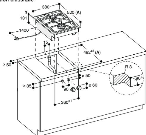
A : si installation avec un couvercle, prendre en considération la découpe la plus profonde (se référer aux schémas de montage séparés)
