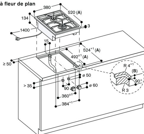
A : si installation avec un couvercle, prendre en considération la découpe la plus profonde (se référer aux schémas de montage séparés)
