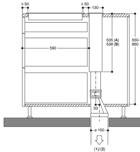
A: Aufgesetzter Einbau
