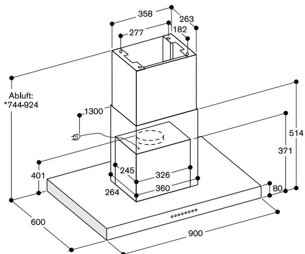
\*Für Deckenhöhen von 2,34 m bis 2,52 m geeignet; Angaben beziehen sich auf den Abstand Fußboden bis Unterkante Esse von 1,60 m.
