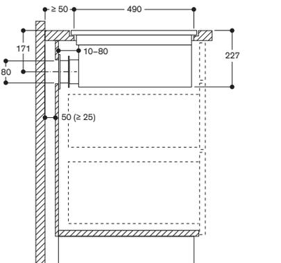
Nicht empfohlen für nicht wärmeisolierte Außenwände oder Böden (U ≥ 0,5 W/m²K)
