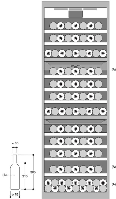
A: Geeigneter Bereich für die Aufbewahrung von Magnum-Flaschen bei der Ausführung mit Standardschublade
