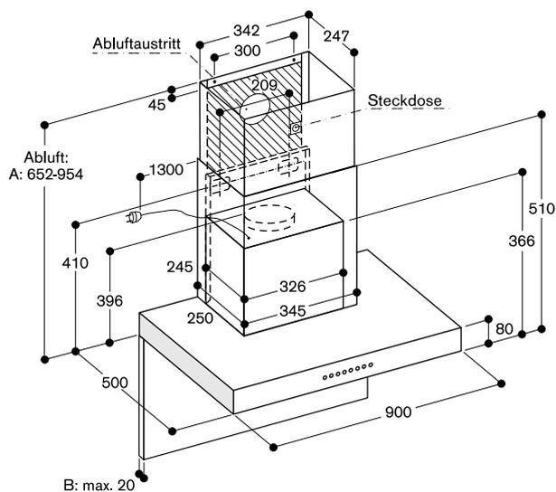
A: Für Deckenhöhen von 2,25 m bis 2,55 m geeignet;
