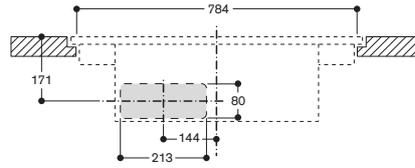
Frontansicht von CV 482 mit geführter Umluft
