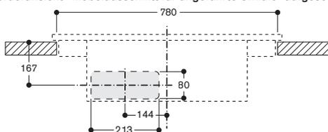
Frontansicht von CV 282 mit geführter Umluft
