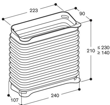
AD851041: Anschlussstutzen für VL400 zur Verlängerung mit NW 150 Flachkanal für extra tiefe Arbeitsplatte
