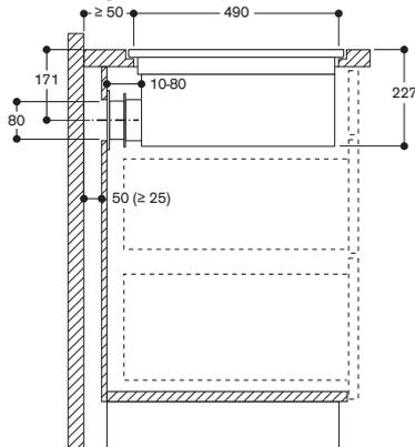
Nicht empfohlen für Umluftinstallationen an nicht isolierten Außenwänden und Böden (Wärmedurchgangswert U ≥ 0,5 W/m²°C)
