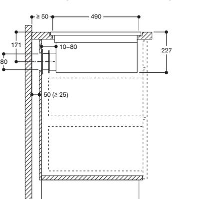
Nicht empfohlen für nicht wärmeisolierte Außenwände oder Böden (U ≥ 0,5 W/m²K)
