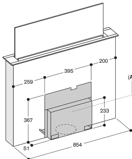
A: Der Zugang zur kompletten Abdeckung muss auch nach der Montage gewährleistet sein
