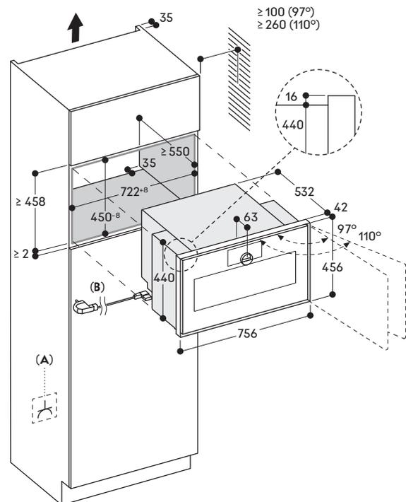
**A:** Frei zugänglicher elektrischer Anschluss
