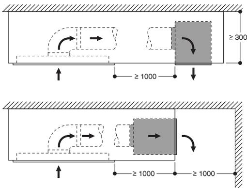
**Empfohlene Konfigurationen für Deckenlüftung Serie 400**
