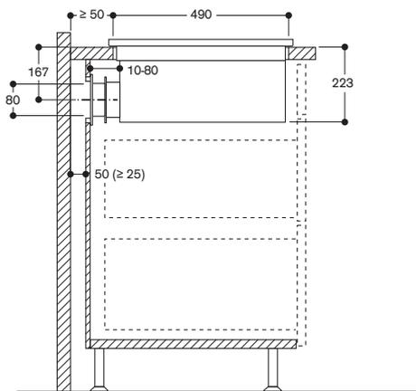
Nicht empfohlen für Umluftinstallationen an nicht isolierten Außenwänden und Böden (Wärmedurchgangswert  $U \geq 0,5 \text{ W/m}^2\text{K}$ )
