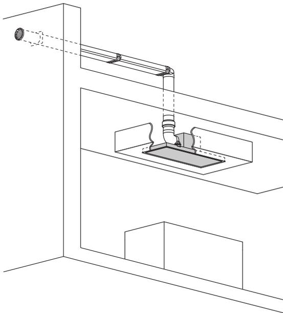
AC250 in einer abgehängten Decke
