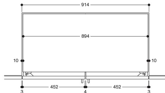
Die resultierenden seitlichen Spalten von 10 mm können mit den Seitenblenden verkleidet werden, die im Installationszubehör RVA460910 enthalten sind.
