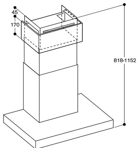
\*Für Deckenhöhen von 2,45 m bis 2,75 m geeignet;
