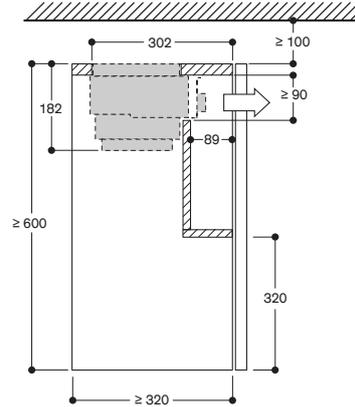
Querschnitt von Oberschrank für AF210 mit AA 211 812 und AA 210 492/460 Absenkrahmen
