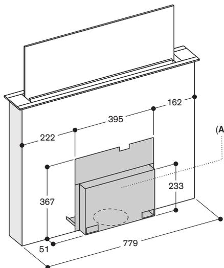
A: Flexible Montage der Lüftereinheit auf der Vorderseite, auf der Rückseite oder mit Abstand vom Gerät (Montageset erforderlich – max. Abstand 3 m)
