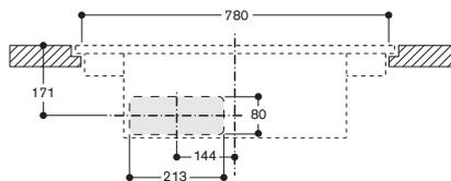
Vorderansicht von CV282 mit ungeführter Umluft.
