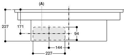
A: Direkt an der Rückseite angeschlossen
