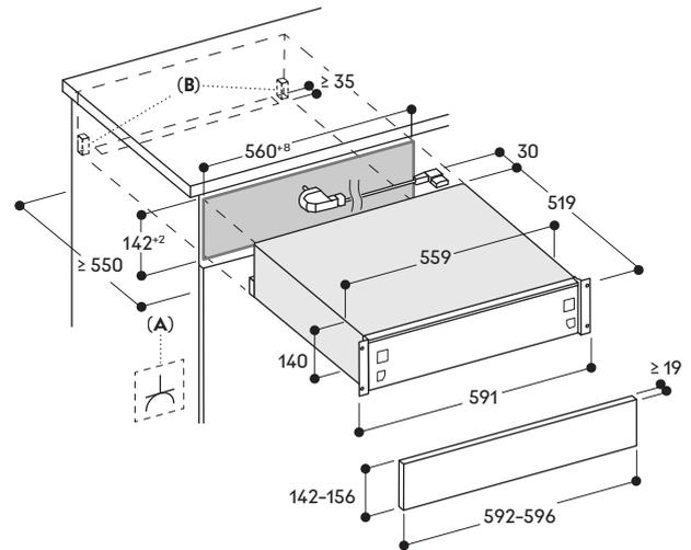
**A:** Frei zugänglicher elektrischer Anschluss
