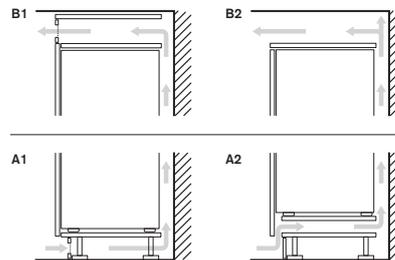
A: Lufteintritt  $\geq 200 \text{ cm}^2$ ; Lüftungsmöglichkeiten A1 oder A2
