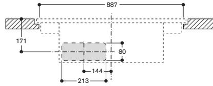
Vorderansicht von CV 492 mit ungeführter Umluft.
