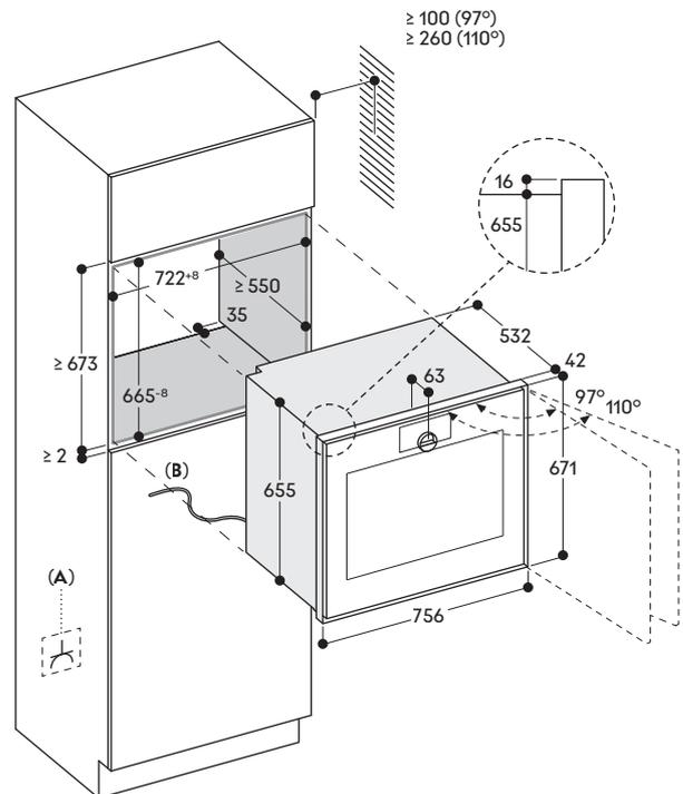
**A:** Frei zugänglicher elektrischer Anschluss
