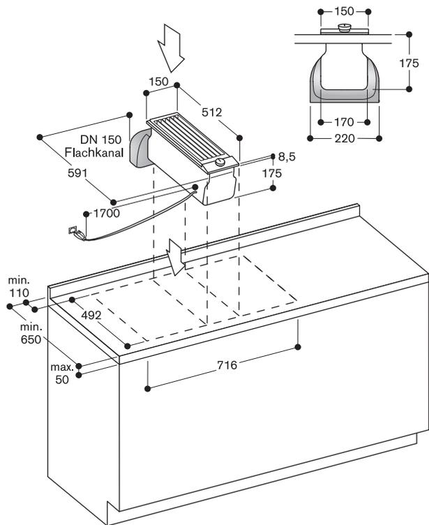
AD 410 040: Flexanschlussstutzen für VL, NW 150 flach
