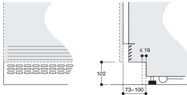
Bei standardmäßiger Einbauhöhe beträgt die Höhe des Sockels 102 mm. Die Höhe des Sockels kann auf 50 mm reduziert werden. Maximale Stärke der Sockelleiste 19 mm.
