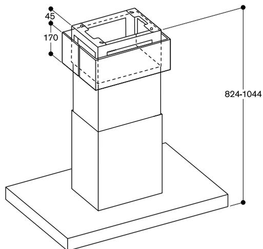
\*Für Deckenhöhen von 2,42m bis 2,64 m geeignet; Angaben beziehen sich auf den Abstand Fußboden bis Unterkante Esse von 1,60 m.
