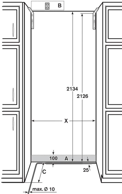
A Bereich für die Installation des Wasseranschlusses
