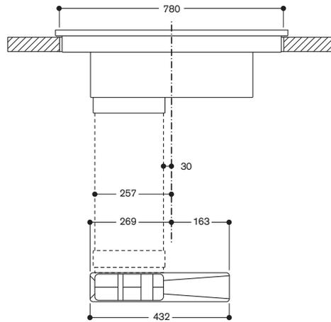
Seitenansicht mit Set geführte Umluft, 700 mm Arbeitsplattentiefe; aufgesetzt eingebaut
