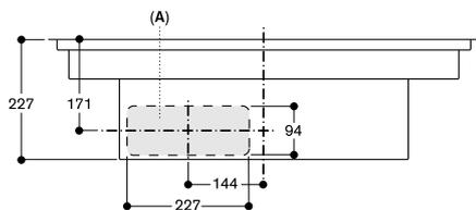
A: Direkt an der Rückseite angeschlossen
