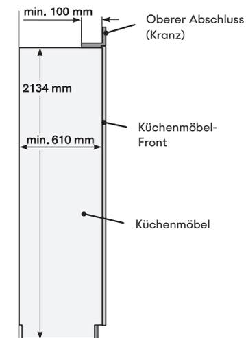
Seitenwände der Einbaunische müssen über die gesamte Tiefe der Einbaunische vollkommen eben und absatzfrei sein.
