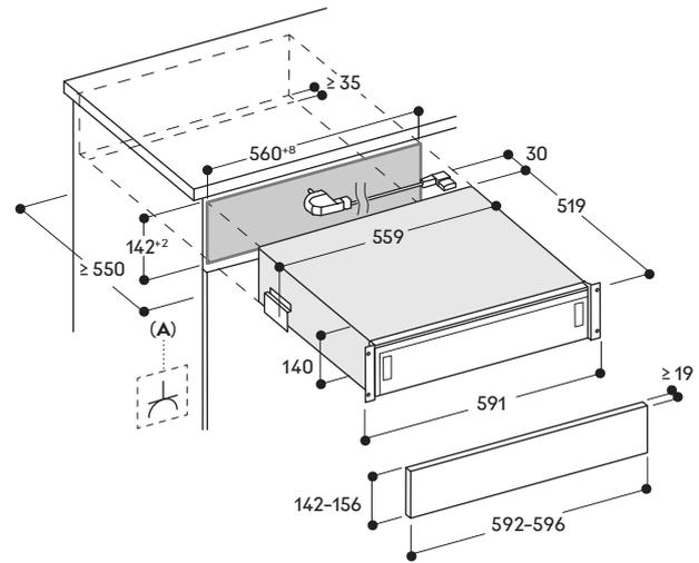
A: Frei zugänglicher elektrischer Anschluss
