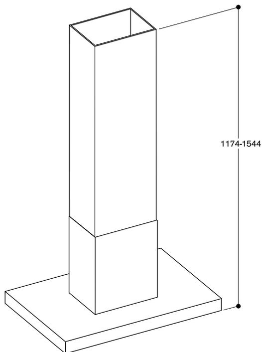
\*Für Deckenhöhen von 2,78 m bis 3,15 m geeignet; Angaben beziehen sich auf den Abstand Fußboden bis Unterkante Esse von 1,60 m.
