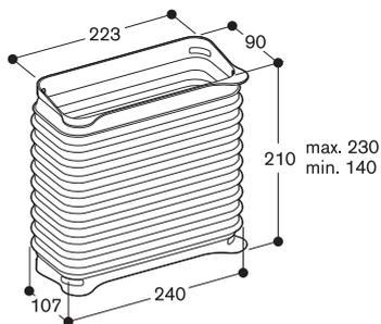
AD 851 041: Anschlussstutzen für VL 200 zur Verlängerung mit NW 150 Flachkanal für extra tiefe Arbeitsplatte
