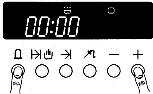
Drücken Sie die Taste „Kurzzeit **13**“ und halten Sie diese gedrückt. Im Anzeigefeld der Zeitschaltuhr erscheint der Wert 0:00. Drücken Sie dann die Taste PLUS **17**, um die gewünschte Zeit einzustellen.
