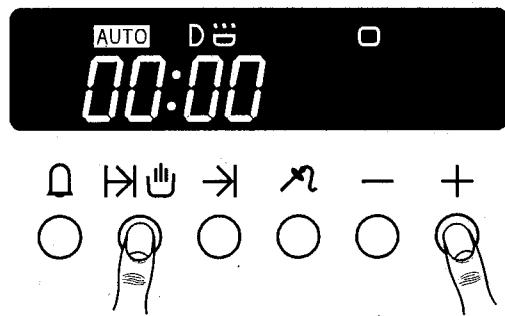
Vier seconden na het programmeren wordt de dagtijd weer aangegeven. De geprogrammeerde duur kan worden gecontroleerd door op de betreffende toets te drukken.
