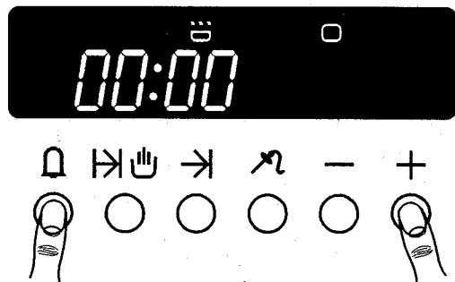
Pulse la tecla "temporización corta **13**". En el cuadro indicador del reloj programador aparece la propuesta de tiempo 0:00. Pulse la tecla **MAS 17**, para programar la hora deseada. En el cuadro indicador se ilumina además los símbolos "Olla **7**", "Horno **10**" y "campana **6**". Tras soltar la tecla "tiempo abreviado **13**" aparece nuevamente la fecha del día en el cuadro indicador.
