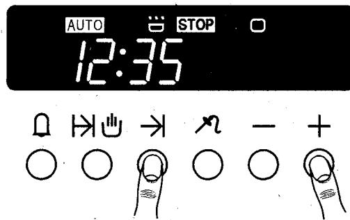
Vier Sekunden nach einem Programmervorgang wird die Tageszeit wieder angezeigt. Die eingestellte Abschaltzeit kann nur auf Tastendruck der entsprechenden Taste abgefragt werden.
