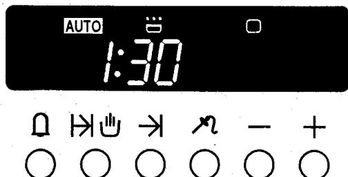
Vier Sekunden nach einem Programmievorgang wird die Tageszeit wieder angezeigt. Die einprogrammierte Dauer kann nur auf Tastendruck der entsprechenden Taste abgefragt werden.
