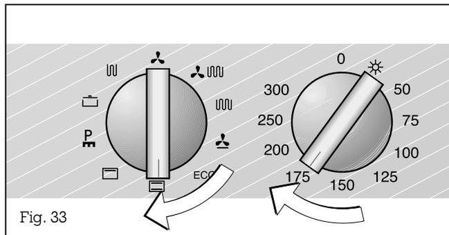
Oltre al classico modo operativo 'Calore superiore ed inferiore', avete anche la possibilità di selezionare separatamente solo il calore superiore. In questo modo operativo potete rosolare la pietanza in modo mirato dall'alto.
