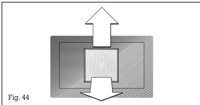
Si consiglia di pulire il filtro dopo 2 cotture o in presenza di uno sporco consistente. Spingete il filtro verso l'alto per smontarlo. Lavatelo in acqua calda e detersivo oppure nella lavastoviglie (Fig. 43). Se lavate il filtro nella lavastoviglie badate a collocarlo verticalmente nel cesto stoviglie affinché non vi si depositino sopra dei residui di cibo. Dopo il lavaggio riagganciate il filtro di nuovo sulla parete posteriore.
