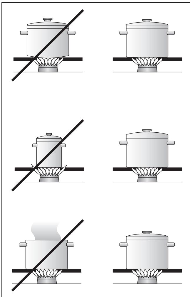
Töpfe mit einem Durchmesser unter **90 mm** bzw. über **280 mm** sollten nicht verwendet werden. Falls Sie größere Töpfe verwenden, achten Sie darauf, dass zwischen Kochgefäß und brennbaren Umbauten ein Mindestabstand von **50 mm** eingehalten wird.
