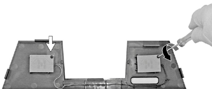
9. Tirer sur les blocs d'éclairage LED pour les sortir.
