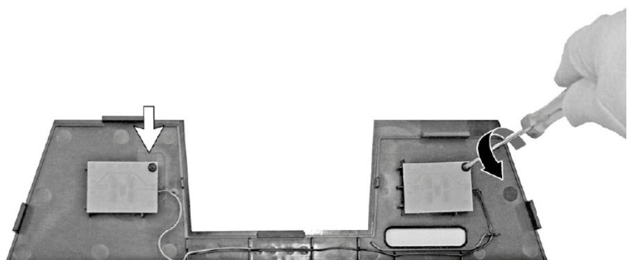
9. Izvucite i uklonite jedinice LED svjetla.
