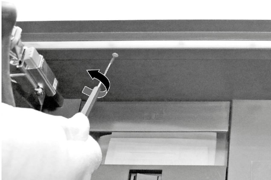
3. Palcom zatlačte hore sprava doľava tak, aby sa uvoľnil prilepený panel.
