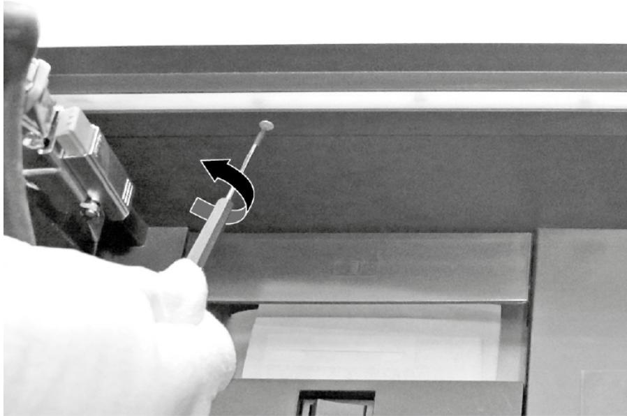
3. S palcem pritiskajte od desno proti levi navzgor, dokler prilepljen okvir ne odstopi.
