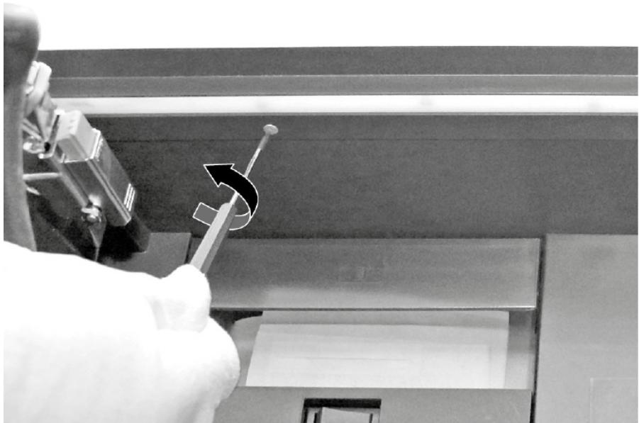
3. Druk met de duim van rechts naar links en naar boven tot het gelijmde paneel loskomt.
