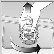
Siebzylinder drehen, Siebssystem entnehmen ...
