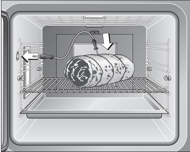
Il termosensore nucleo consente una cottura esatta ed estremamente precisa.
