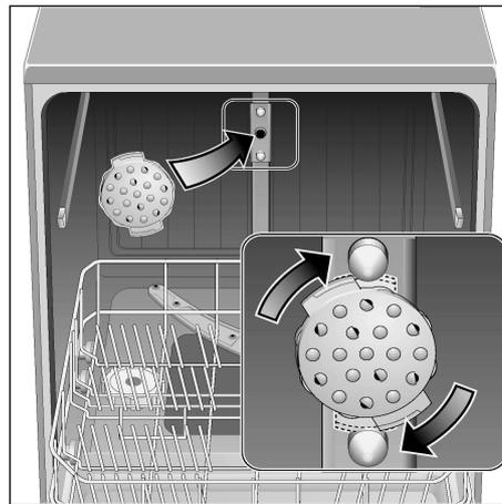
Damit der Sprühstrahl alle Teile erreichen kann, ordnen Sie die Bleche wie abgebildet ein (max. 4 Backbleche und 2 Gitter).
