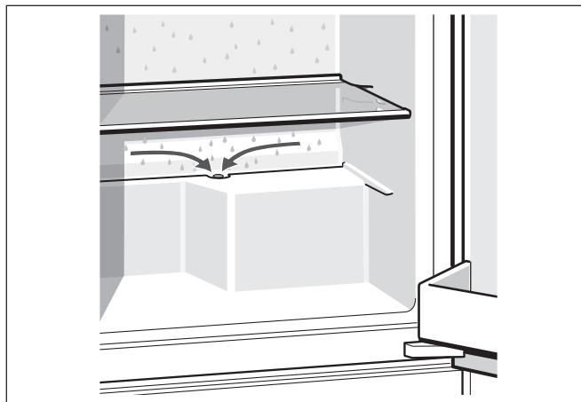
La parete posteriore si sbrina automaticamente. L'acqua di sbrinamento si raccoglie nel convogliatore di scarico. Dal convogliatore di scarico l'acqua di sbrinamento scorre sul gruppo frigorifero e qui evapora.
