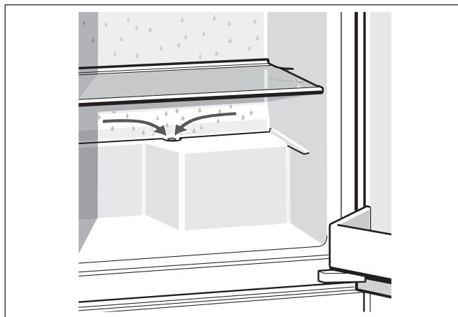
De achterwand wordt automatisch ontdoooid. Het dooiwater loopt via het afvoergootje naar de koelmachine, waar het verdampst.
