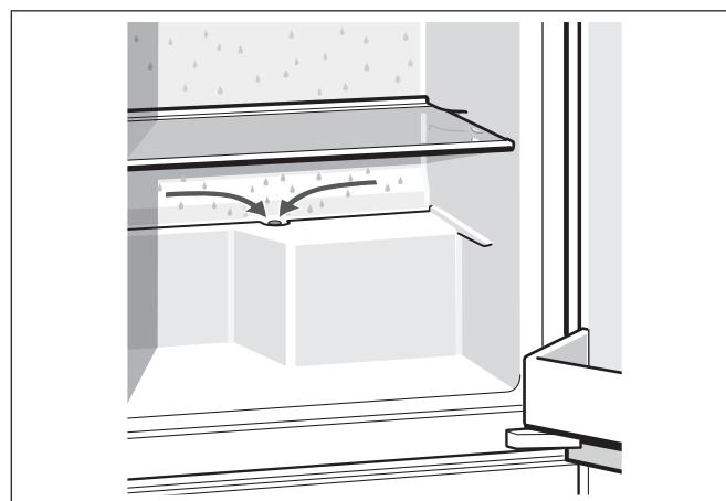
No es necesario raspar la escarcha ni secar las gotas de agua, dado que se descongela automáticamente. El agua de descongelación es recogida en la canaleta de desagüe volviendo al grupo frigorífico, donde se evapora.
