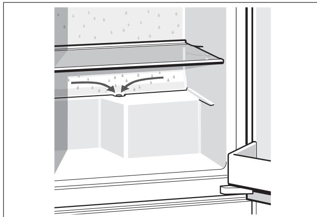
Die Rückwand taut automatisch ab. Das Tauwasser läuft in die Tauwasser-Rinne. Von der Tauwasser-Rinne läuft das Tauwasser zur Kühlmaschine, wo es verdunstet.
