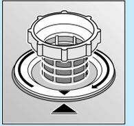
enroskar el filtro cilíndrico
