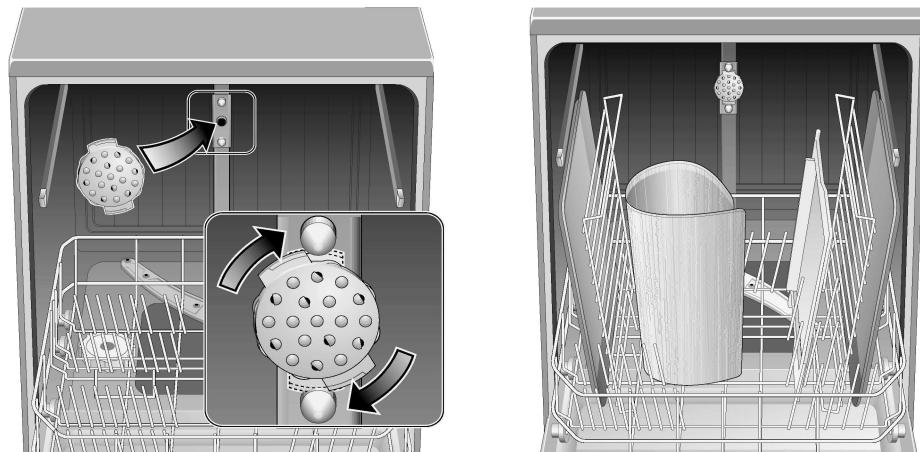
Große Bleche oder Gitter sowie Teller mit einem Durchmesser mehr als 30 cm (Gourmetteller, Pastateller, Platzteller) können Sie mit Hilfe dieses Sprühkopfes reinigen.
