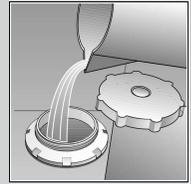
**Avant le premier lavage seulement,** versez **env. un litre d'eau** dans l'orifice du réservoir de sel.
