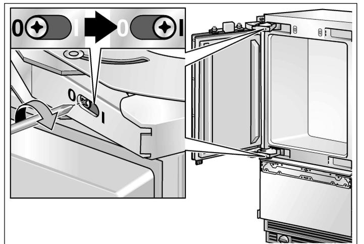
❑ Tensione el muelle de la bisagra. Ajuste el tornillo de 0 a I. Sujete luego la caja de cobertura de la bisagra.
