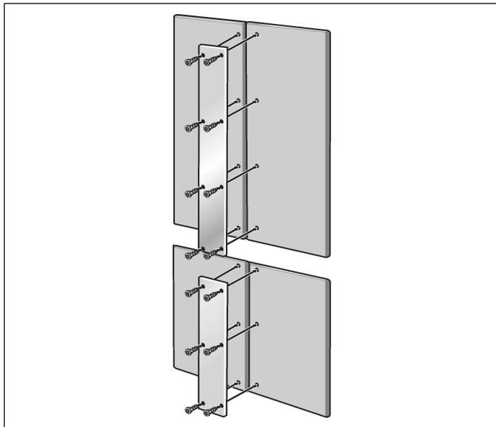
Lorsque vous fixez le bandeau métallique aux portes de meuble, respectez la longueur maximum possible des vis et la position des trous de perçage. Vissez toujours dans la partie du matériau de porte la mieux en mesure de supporter la charge.
