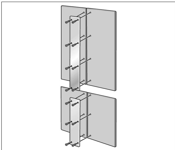
Cuando sujete el listón metálico a la puerta de los muebles, tenga en cuenta de usar los tornillos de la mayor longitud posible y la posición de las perforaciones. Atornille siempre en el material de mejor capacidad de carga de la puerta del electrodoméstico.
