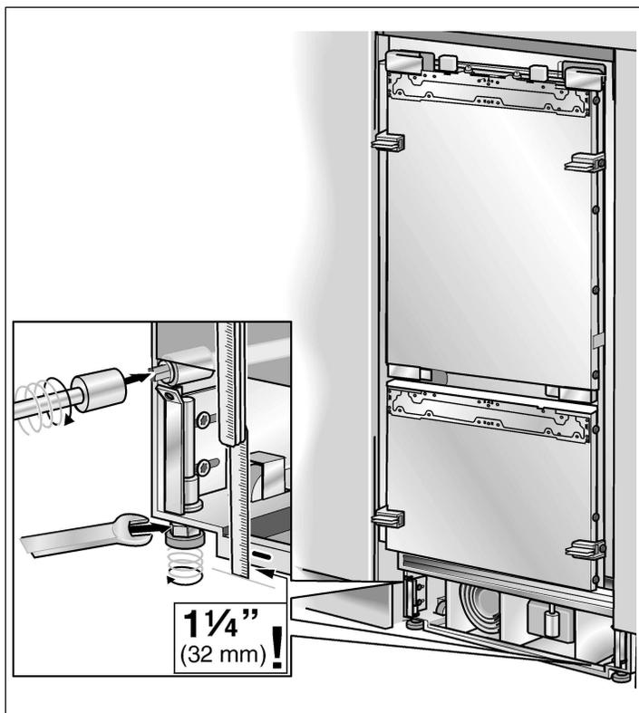
Como medida sugerida para el ajuste de la altura, se ha practicado una marca en la pata del equipo. Durante el ajuste, esta marca debe ajustarse esta marca a una altura de 1¼" (32 mm) sobre el nivel del suelo.
