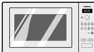
Cihaz bir soğutma fanı ile donatılmıştır. Cihaz kapatılmış olsa da, fan çalışmaya devam edebilir.
