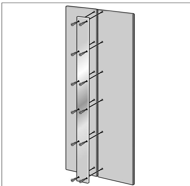
Ce bandeau métallique est disponible chez votre revendeur et constitue un accessoire d'installation (accessoire de jonction entre portes de meuble). Détails à ce sujet : voir la section «Accessoires et outillage nécessaires», page 16.
