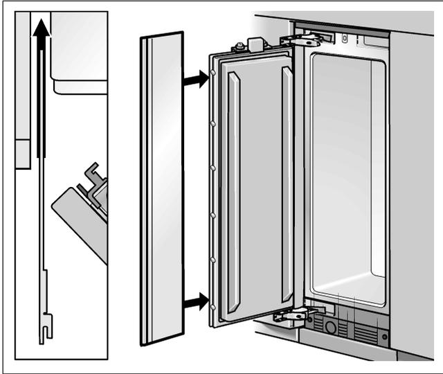
Le bandeau protège-doigts doit être facile à insérer et extraire !
