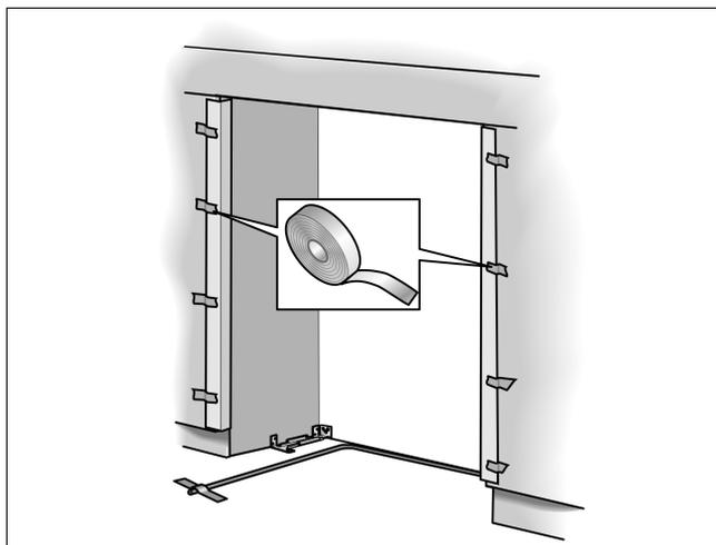
Pour protéger les bords de la cavité d'installation, utilisez les cornières de protection livrées d'origine et fixez-les avec du ruban adhésif.
