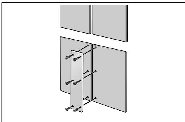
Ce bandeau métallique est disponible chez votre revendeur Gaggenau et constitue un accessoire d'installation (accessoire de jonction entre portes de meuble) ; pour plus de détails à ce sujet, voir la section « Accessoires et outillage nécessaires ».
