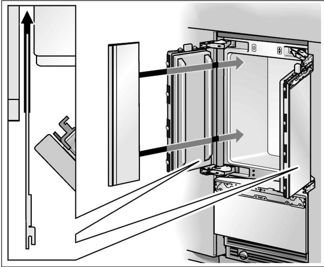
Le bandeau protège-doigts doit être facile à insérer et extraire !
