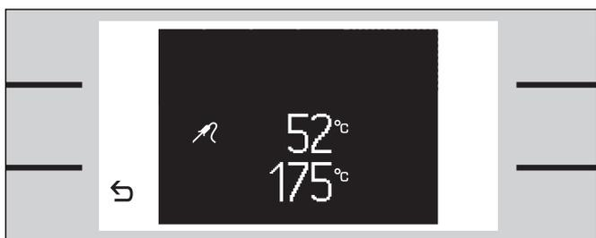
E' possibile programmare la temperatura nucleo per la pietanza da preparare. L'apparecchio si spegne quando questa è stata raggiunta all'interno della pietanza.
