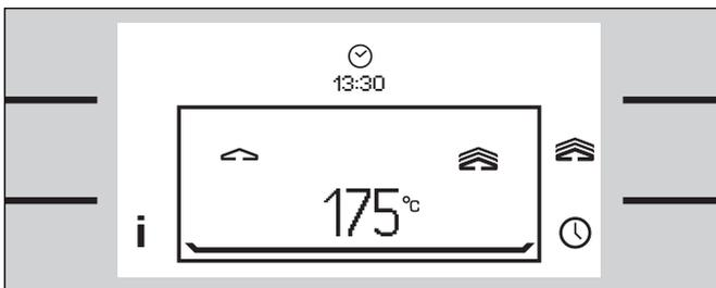
Uniquement en cas d'utilisation du faitout : lorsque le niveau de cuisson pour saisie est sélectionné, le four chauffe à pleine puissance pendant 3 minutes.
