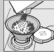
**Spezialsalz** einfüllen (nie Reiniger einfüllen!).
