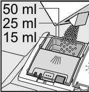
**Reiniger** nur in trockene Reinigerkammer einfüllen.
