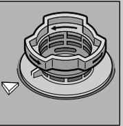
Avvitare il sistema di filtraggio. **RISPETTARE IL RIFERIMENTO!**
