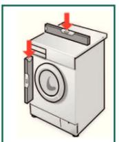
3. Serrez le contre-écrou contre la carrosserie de l'appareil. Ce faisant, maintenez le pied et veillez à ce que sa hauteur ne change pas.
