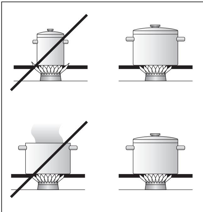
Töpfe mit einem Durchmesser unter **160 mm** bzw. über **320 mm** sollten nicht verwendet werden. Falls Sie größere Töpfe verwenden, achten Sie darauf, dass zwischen Kochgefäß und brennbaren Umbauten ein Mindestabstand von **50 mm** eingehalten wird.
