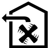
Tuuletin imee keittiöhöyryt ja johtaa ne rasvasuodattimen ja putkiston kautta puhdistettuna ulos.
