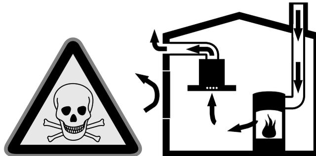
Huoneilmaa tarvitsevat tulisijat (esim. kaasu-, öljy-, puu- tai hiilikäyttöiset lämmityslaitteet, läpivirtauskuumennin, vedenkuumennin, keittotasot, leivinuunit) ottavat polttoilman huonetilasta ja johtavat poistoilman poistoilmalaitteen (esim. savutorven) kautta ulos.
