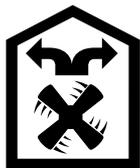
Liesituulettimen imemä ilma palautetaan rasvasuodattimen ja aktiivihiilisuodattimen puhdistamana takaisin keittiöön.
