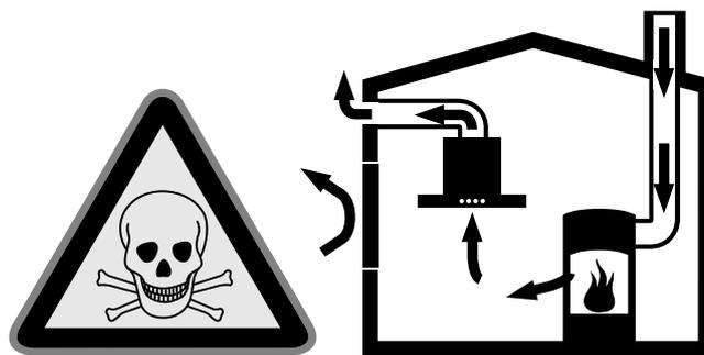
Eldstäder som är beroende av rumsluft (t.ex. värmeapparater som drivs med gas, olja, ved eller kol, genomströmningsapparater, varmvattensberedare, spishällar och ugnar) tar upp sin förbränningsluft ur det rum där de är installerade och leder ut avgaserna genom en avgasanläggning (t.ex. skorsten) i det fria.
