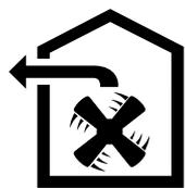
Den insugna luften rengörs via fettfiltren och leds genom ett rörsystem ut i det fria.
