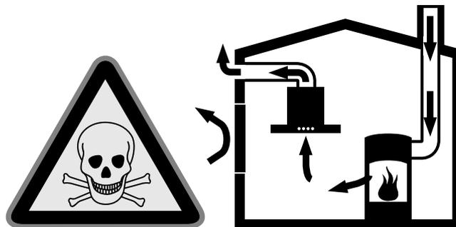
Ildsteder, der er afhængige af indeluften, (f.eks. gas-, olie-, ved- eller kuldrevne varmeapparater, gennemløbsvandvarmere, vandvarmere, kogetoppe og bageovne) henter forbrændingsluft fra opstillingsrummet og leder røggasser gennem et røggasanlæg (f.eks. skorsten) ud i det fri.
