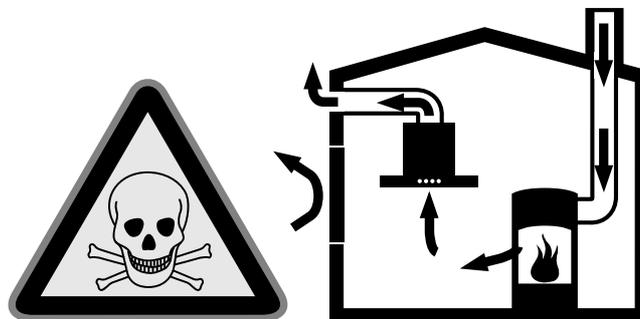
Ildsteder som er avhengig av romluften (f. eks. varmeapparater som drives med gass, olje eller kull, varmtvannsbereidere, koketopper og stekeovner) bruker forbrenningsluften fra oppstillingsrommet og leder avgassene gjennom et avgassanlegg (f. eks. skorstein) i det fri.
